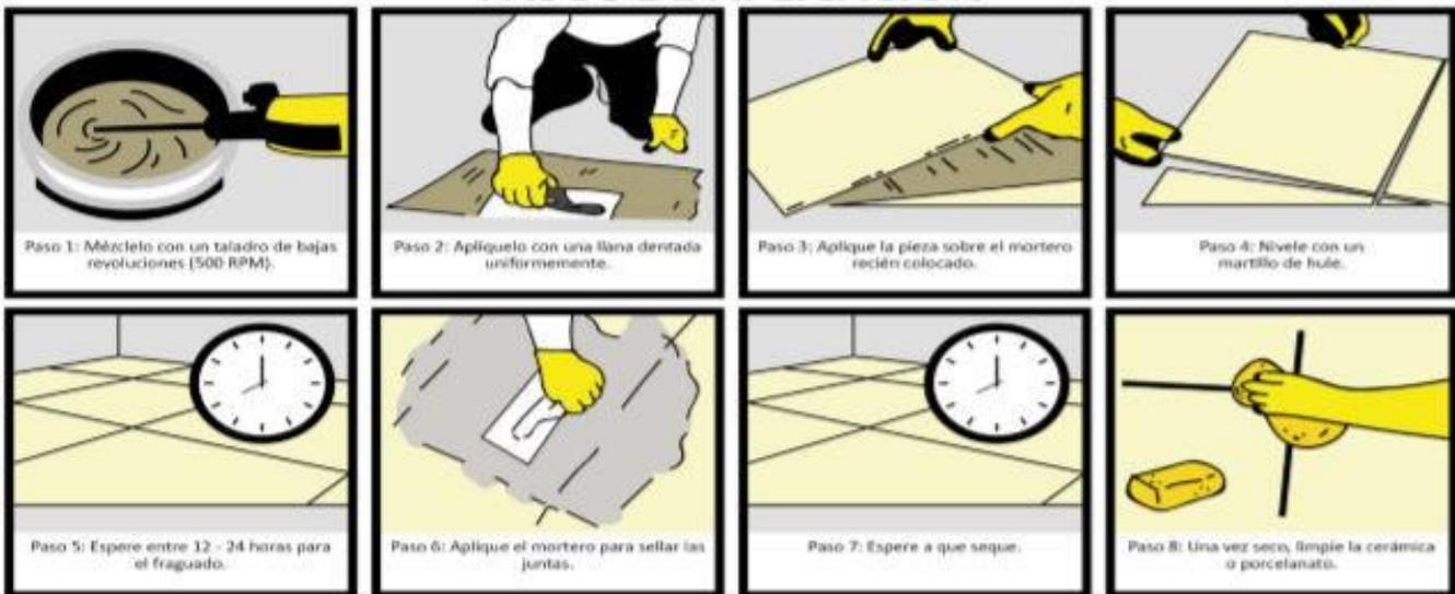
Extender la mezcla de PLANICEM NP con una llana metálica en un área de 1 a 1.5 m<sup>2</sup> dependiendo el espesor. Usar la parte dentada de la llana para dejar surcos bien definidos que facilitarán la distribución del adhesivo. Coloque la pieza de a pegar asegurándose que no tenga polvo u otros materiales que impidan la adherencia.
