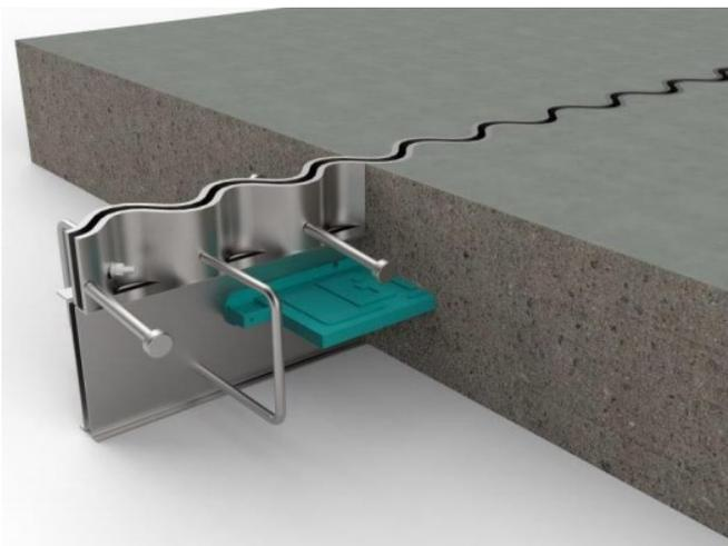
La junta tipo S está diseñada para espesores de losa de piso de 100 mm a 300 mm, y apertura de la junta hasta 20 mm. Para el resto de espesores de losa y apertura de juntas mayores, se puede diseñar y suministrar las juntas según requisitos del cliente.
