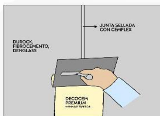
Paso No.4 Aplique la primera capa de DECOFLEX con una espátula o plana lisa.
