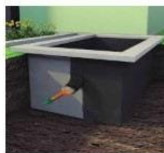
Para impermeabilizar jardineras que van a ser enterradas
